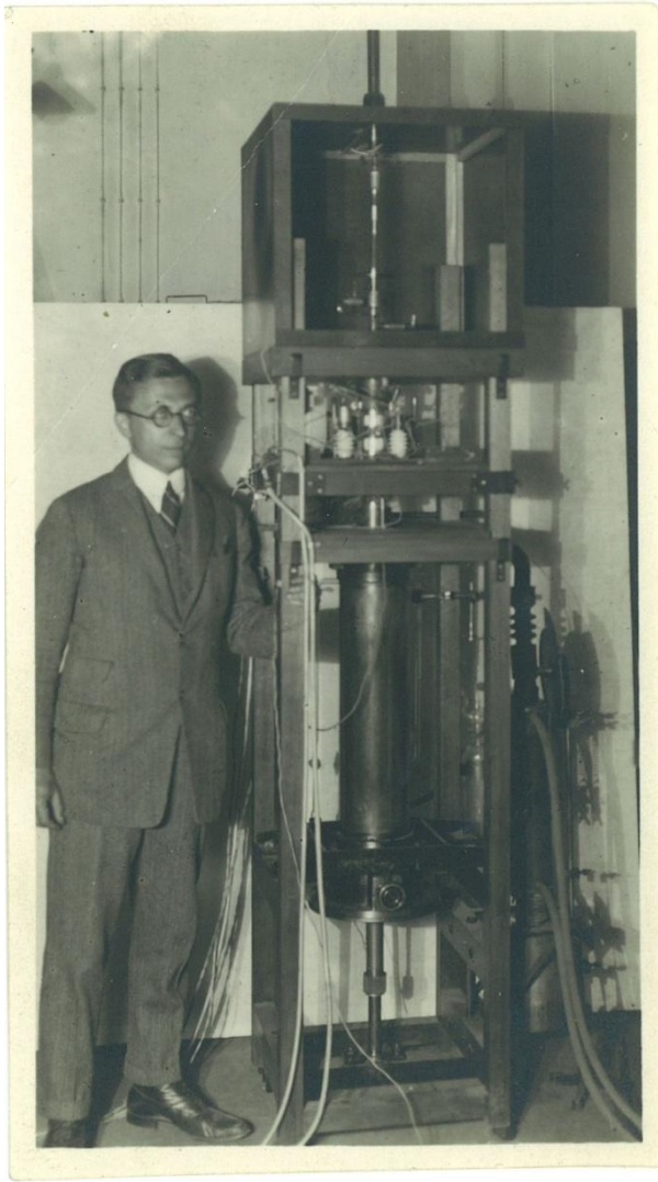
Abbildung 7: Links: Gábor mit dem Oszillographen, oben die Erzeugung des Elektronenstrahls, in der Mitte die elektrostatische Ablenkung, unten die Kassette für die photographische Platte, ganz rechts die Hochvakuumpumpe. Rechts: Oben Kippgerät, darunter die Spannungsversorgung mit Batterien
