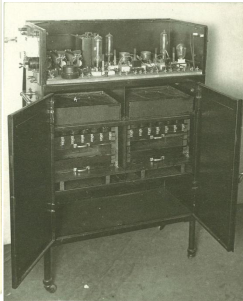
Abbildung 7: Links: Gábor mit dem Oszillographen, oben die Erzeugung des Elektronenstrahls, in der Mitte die elektrostatische Ablenkung, unten die Kassette für die photographische Platte, ganz rechts die Hochvakuumpumpe. Rechts: Oben Kippgerät, darunter die Spannungsversorgung mit Batterien
